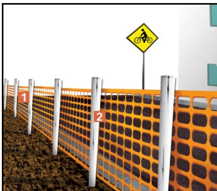
Figura 01 – Cerca de tela para isolamento de obra
